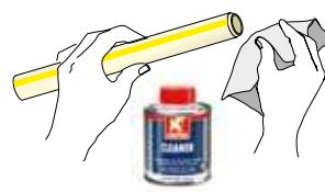
Před zahájením samotného lepení je třeba použít čistič (CLEANER), což má za cíl předběžné zméklení a také očištění ploch spojovaných součástí. Pomocí hadříku nasáklého čističem potírejte spojované části.
