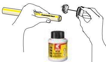
Následně, po zaschnutí ploch, na ně naneste vhodné lepidlo. Lepidlo nanášejte jak na trubku, tak dovnitř tvarovky.
