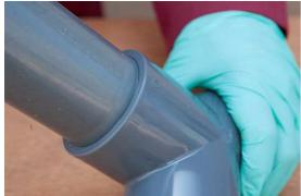
Sofort nach dem Auftragen des Klebstoffs die Teile mit fließender, gleichmäßiger Bewegung zusammensetzen und einige Sekunden lang festhalten. Die Verbindung darf während der ersten 15 Minuten nicht mechanisch belastet werden. Bei Temperaturen unter 10 °C verlängert sich diese Wartezeit auf mindestens 30 Minuten.
