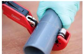
Rohr rechtwinklig abschneiden oder absägen. Grate im Inneren entfernen und das Rohr an der Außenseite 15° anfasen.
